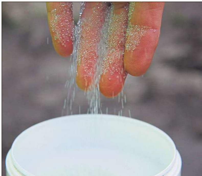
Glaskugeln sollen verhindern, dass Sand in das Wasser gelangt. Die feinen Kugeln sind rund einen Millimeter groß.
